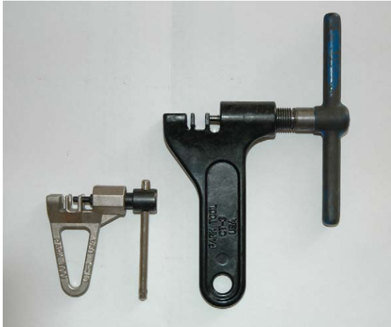
Zum Vergleich, das Reise- und das Werkstattmodell eines Kettennietendrückers.
